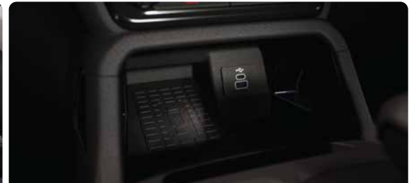
ប្រព័ន្ធលោកត្រូវស៊ីរីឡី (Wireless Charging) រន្ធលោក USB និង USB Type C
