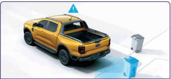
ប្រព័ន្ធចាប់ប្រៀងបន្ទាន់ពេលឆ្ងាយដោយស៊ីយប្រវត្ត
